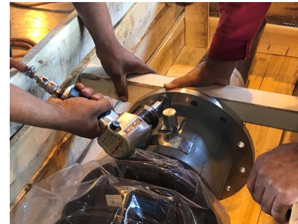
شکل ۹ استفاده از پیچهای خودکار برای محکم نمودن فلنج بوشینگ به جعبه حمل Fig. 9 Using self-tapping screw to connect bushing's flange to crate
