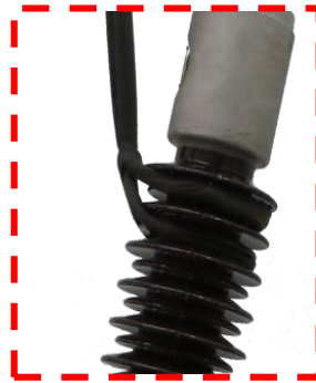
شکل ۱۵ ب نمای نزدیک چگونگی پیچاندن طناب به دور مقره بوشینگ برای حمل آن Fig. 15.B Close view of using ropes on porcelain side of bushing for horizontal handling
