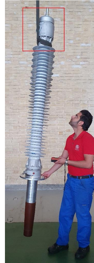
شکل ۱۶الف جزئیات چگونگی پیچاندن طناب به دور فلنج فوقانی مقره سیلیکونی برای حمل آن و روش حمل افقی بوشینگ Fig. 16.A Details of using ropes on Silicone side of bushing and horizontal handling of that
