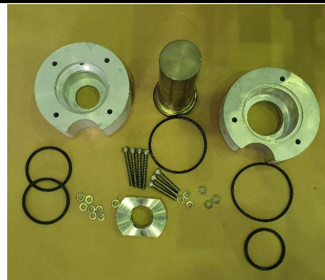
شکل ۳۰ - قطعات مونتاژ نهایی بوشینگ های SGB1-450-3150-CTE=300 و SGB1-650-3150-CTE=300 Fig. 30 The parts related to final assembly for the Bushings SGB1-450-3150-CTE = 300 and SGB1-650-3150-CTE = 300
