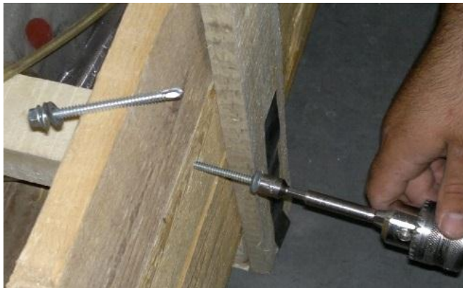
شکل ۸ استفاده از پیچهای خودکار برای اتصال قطعات چوبی جعبه حمل Fig. 8 Using self-tapping screw to connect wooden members in crate
