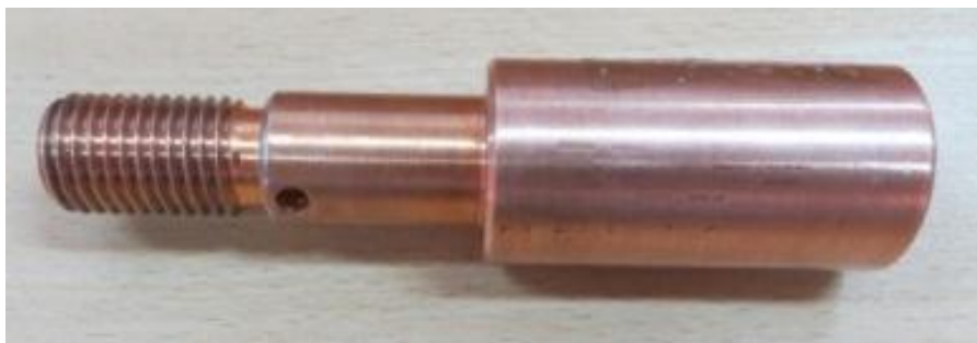
شکل ۲۳ سرکابل مسی Fig. 23 Draw-lead
