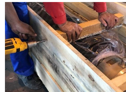
شکل ۱۲ روش صحیح باز کردن در جعبه حمل یا جدا نمودن ساپورت ها
