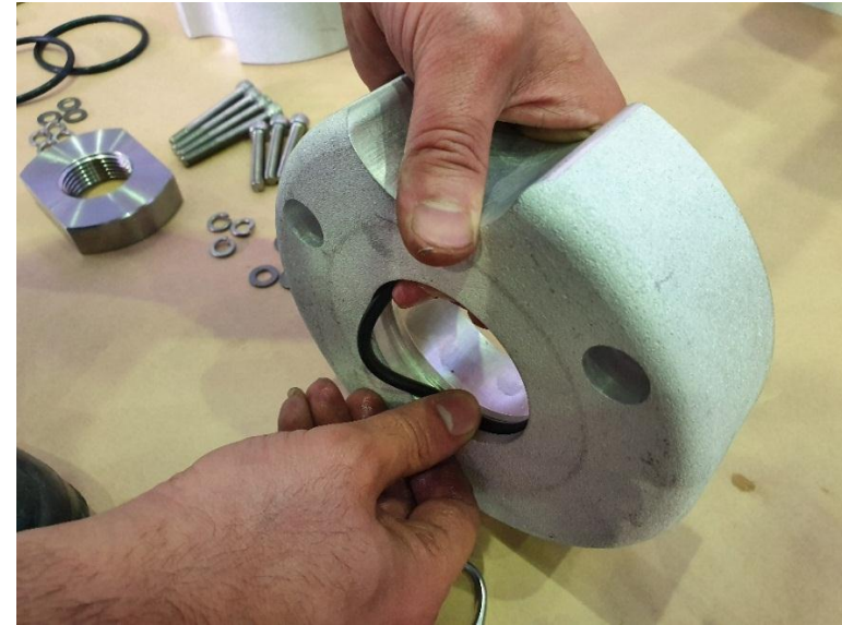
شکل ۴۶ - جایگذاری اورینگ روی قطعه "Top Flange" Fig. 46 Placement of O-Ring on "Top Flange"
