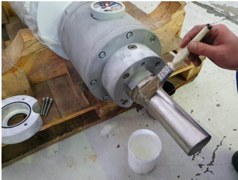
شکل ۵۴ - مالیدن وازلین بروی ناحیه پایینی قطعه "HV Connection" Fig. 54 Rubbing vaseline on the lower part of "HV Connection"
