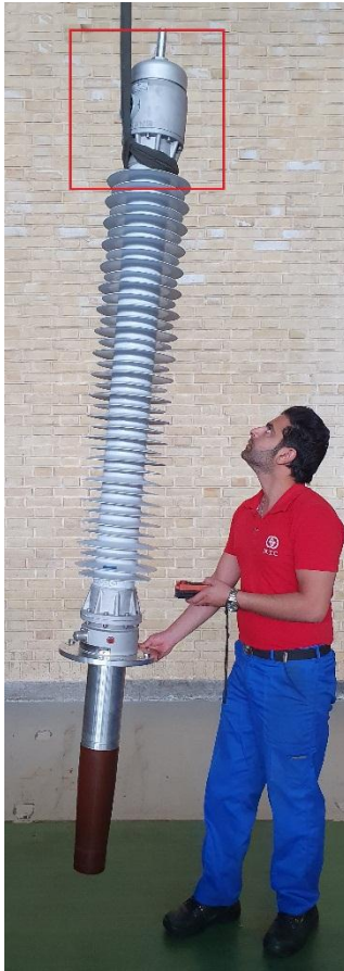
شکل ۱۴ب روش صحیح بلند کردن و عمودی نمودن بوشینگ مدل SGB1 Fig. 14.B Correct way of lifting and erecting bushing type SGB1
