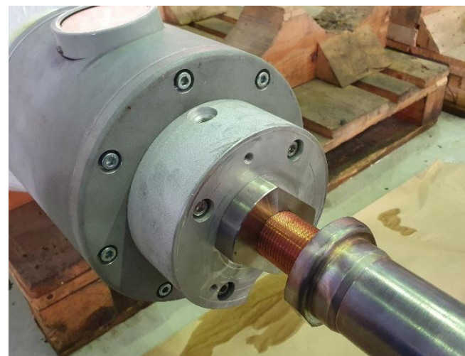
شکل ۵۱ - بستن قطعه "HV Connection" بر روی کانداکتور مسی Fig. 51 Tightening "HV Connection" on "Cu conductor"
