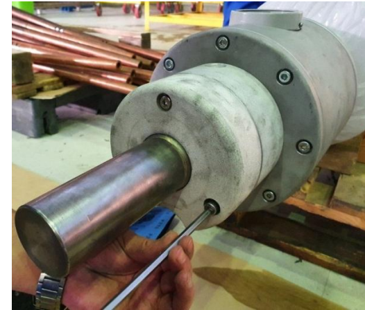
شکل ۲۴ - باز کردن پیچ های آلن از روی قطعه "Cap HV Connection" "Fig. 1 Remove allen screws from "Cap HV Connection"
