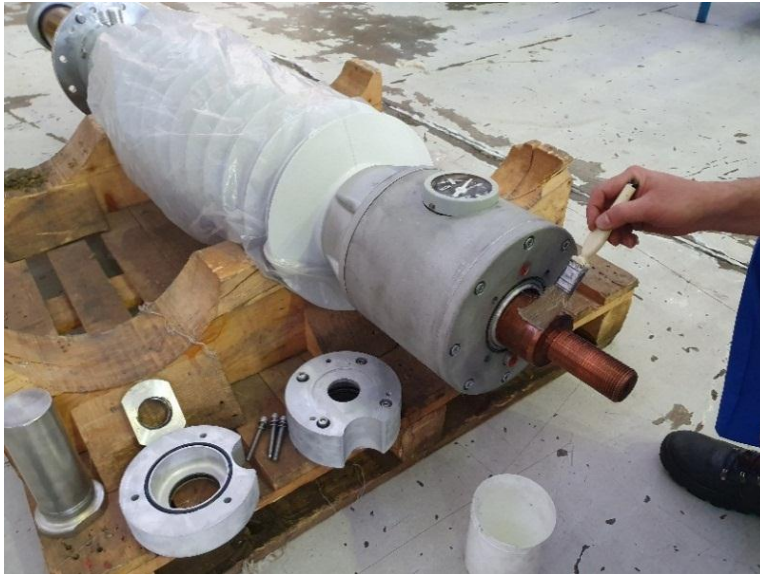
شکل ۴۷ - وازلین زدن بر روی قسمت فوقانی کانداکتور پیش از جا زدن قطعه "Top Flange" Fig. 47 Rubbing vaseline on the top part of the conductor before inserting the "Top Flange"
