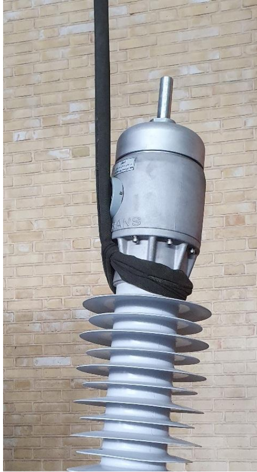
شکل ۱۶ب جزئیات چگونگی پیچاندن طناب به دور فلنج فوقانی مقره سیلیکونی برای حمل آن و روش حمل افقی بوشینگ Fig. 16.B Details of using ropes on Silicone side of bushing and horizontal handling of that
