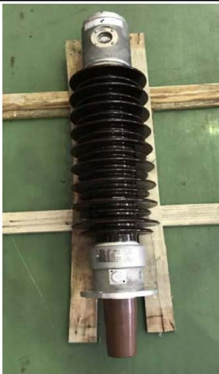
شکل 2-9- نگهداری مناسب بوشینگ در حالت افقی
