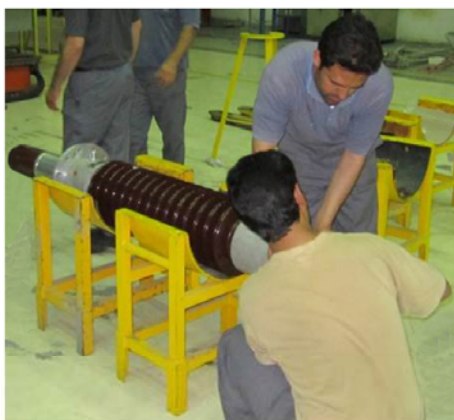
شکل 9-1- نگهداری مناسب بوشینگ در حالت افقی
