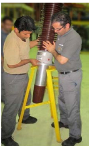
شکل 8- نگهداری مناسب بوشینگ در حالت عمودی
