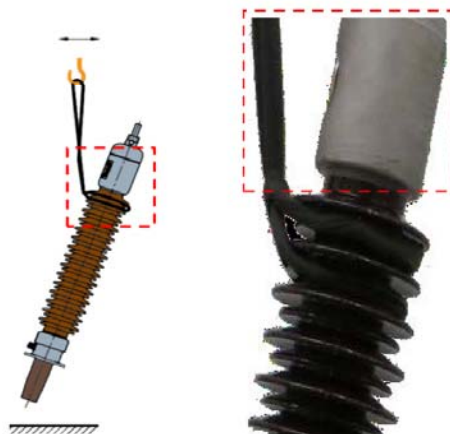
شکل 7- روش صحیح حمل افقی بوشینگ
