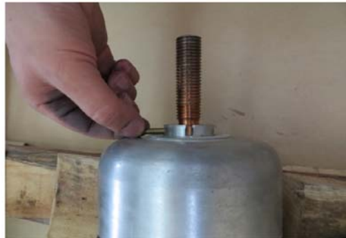
شکل 16- خارج کردن پین نگهدارنده بالای درپوش فوقانی
