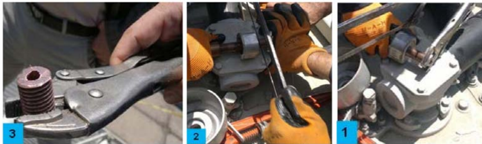
شکل 28- برش مقدار طول اضافی از سوزنی قدیمی
