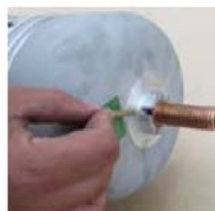
شکل 12- خارج نمودن پین نگهدارنده
