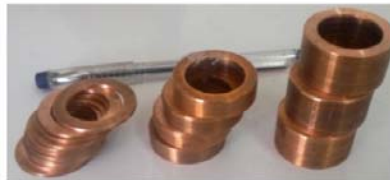
شکل 31- واشرهای مسی برای پر کردن فاصله بین دو سوزنی
