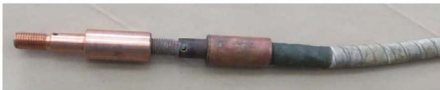
شکل 25- بستن سوزنی جدید روی مجموعه سوزنی و کابل مسی قدیمی
