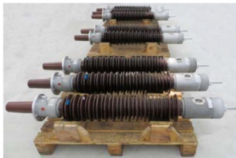
شکل 4- چرخش پوشینگ حول محور طولی مجاز نیست.
