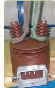
روش صحیح و ایمن بلند کردن ترانس
