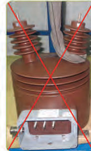
روش نادرست و غیر ایمن بلند کردن ترانس
