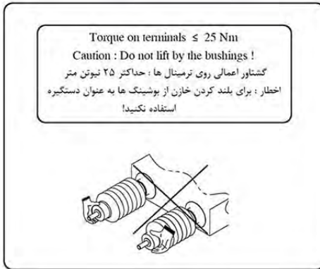
روش نادرست جابجایی خازن
